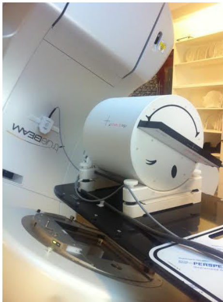
4. ábra A PTW Octavius 4D rendszer működése a minőségbiztosítási mérés közben
