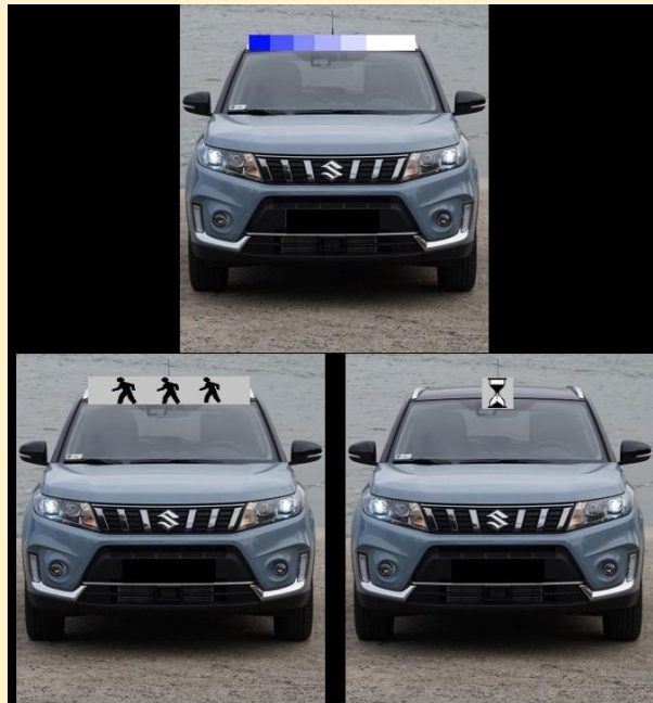
3. ábra: A jármű szélvédője felett elhelyezett panel lehetséges jelzései.
