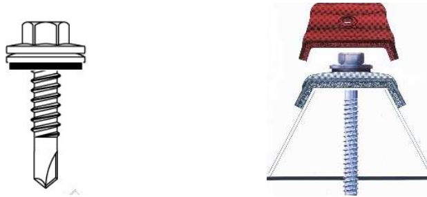
5. ábra Önfúró csavar, illetve egy lehetséges trapézlemez rögzítés
