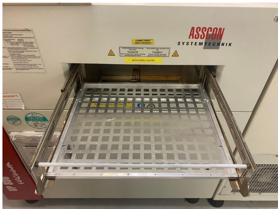
9. ábra: Az új rács beszerelve a berendezésbe
