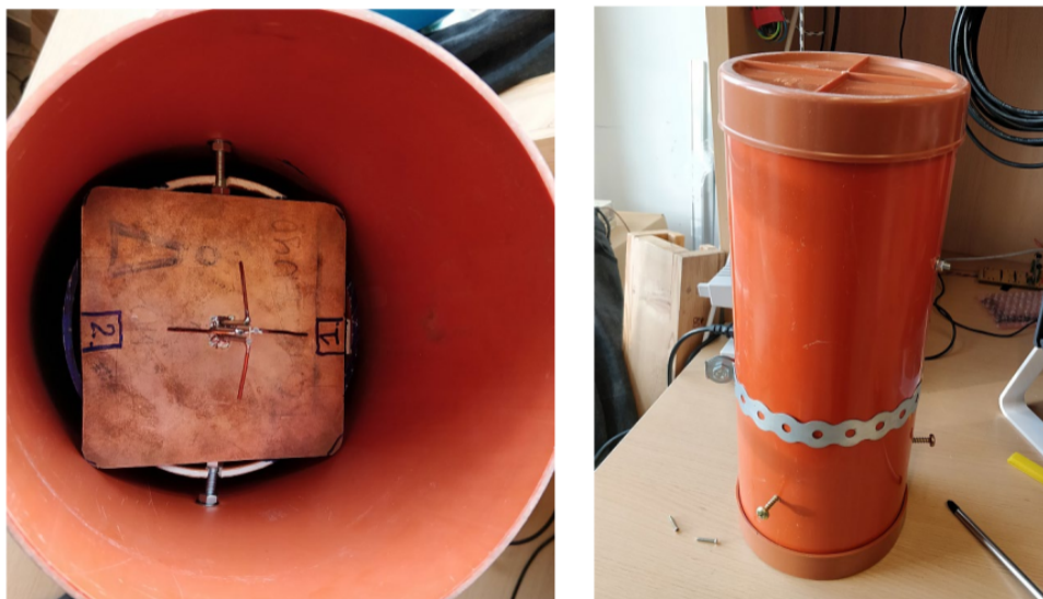
2.2. ábra. A megvalósított primer sugárzó antenna, és borítása
