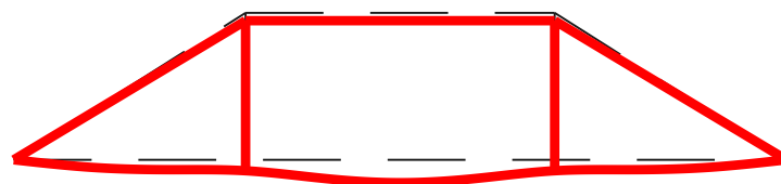
28. ábra: Kettős függesztőmű optimált alakjának lehajlása
