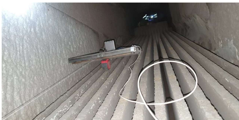
4. ábra: Letisztított lánclemezek és mérőműszer a lánccsatornában [8]
