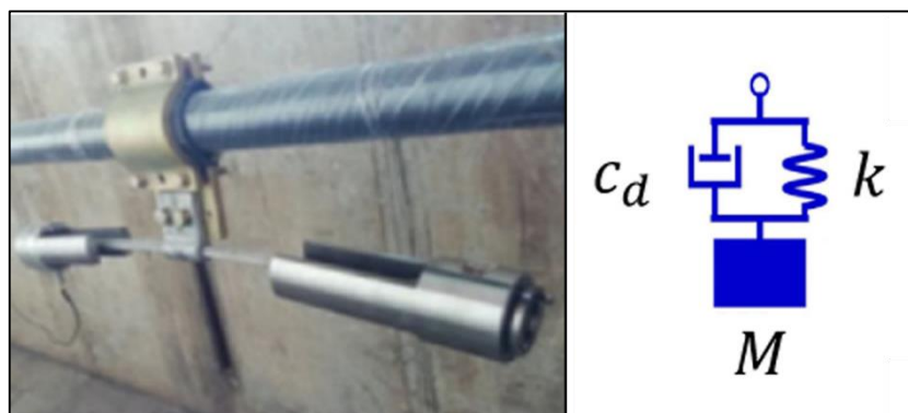
10. ábra: TMD - csillapító mechanikai modelljével [9 alapján]
