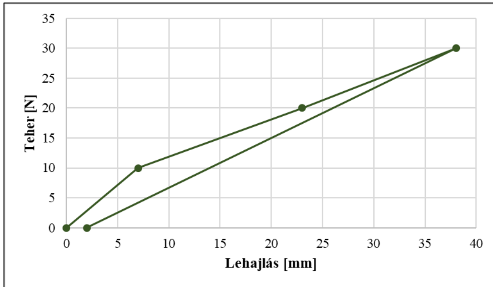
26. ábra: Messenger kábel jellemző erő-elmozdulás diagramja
