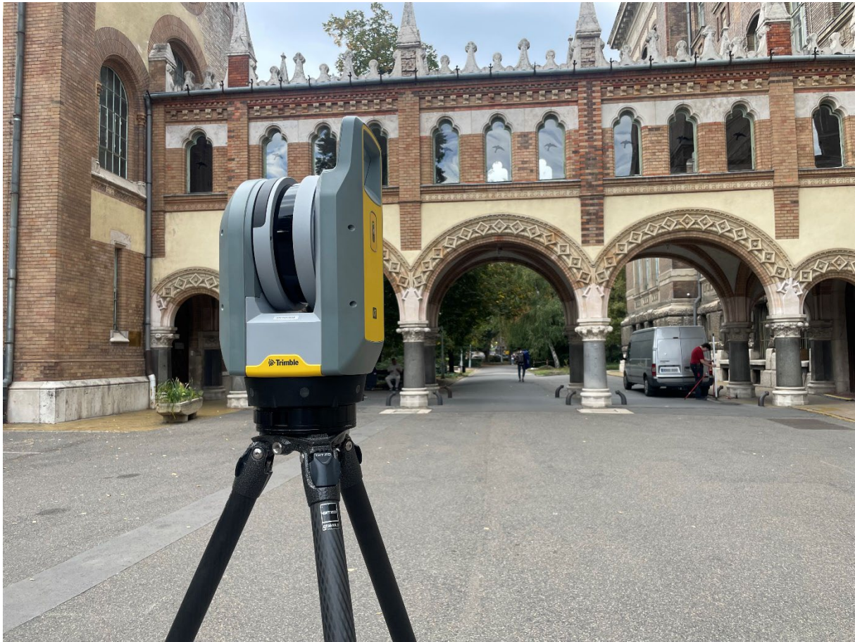
3. ábra - Trimble X7 lézerszkennő
