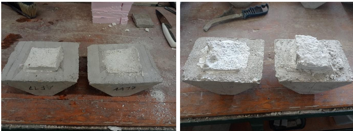
24. ábra: 1 illetve 2 cm vastag habarcos törési képe
