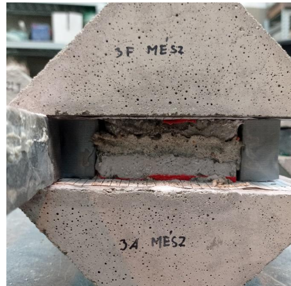
14. ábra: Az illesztett próbatesszal 4. falának kiegyenlítése
