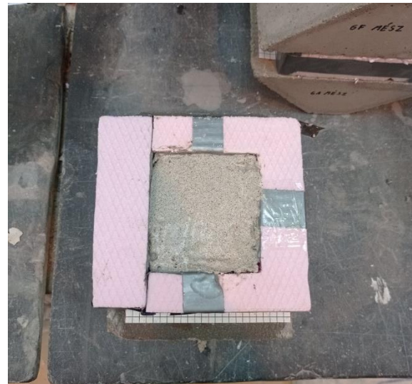
12. ábra: Próbatesszálhabarccsal kitöltve
