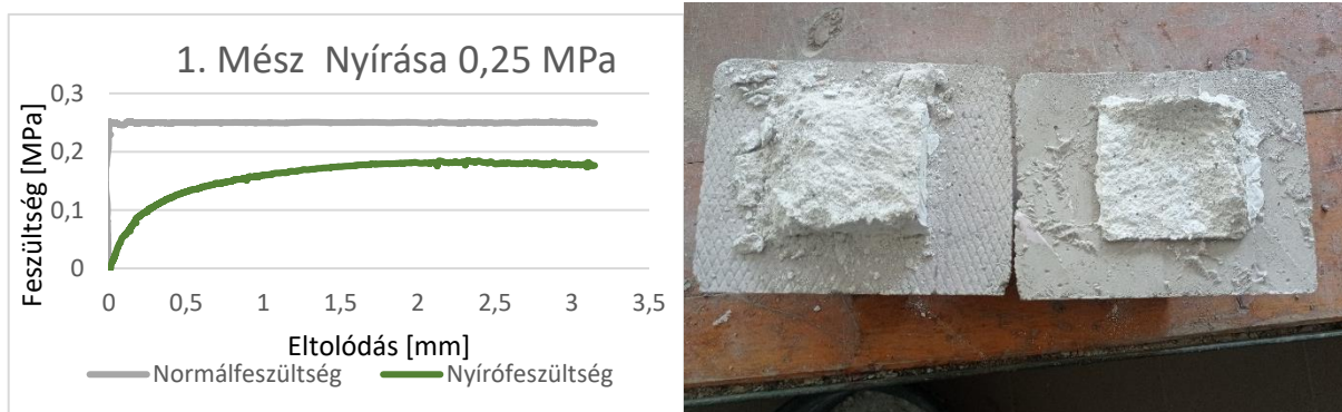
19. ábra: Mészhabarcs kapcsolatú próbatest jellemző tönkremeneteli módja
