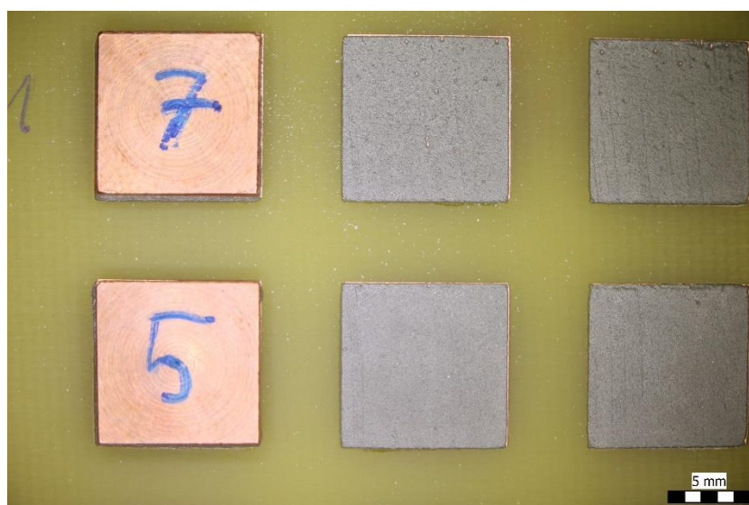
4-9. ábra Beültetett réztömbök (PCB0 pad01 és pad02)
