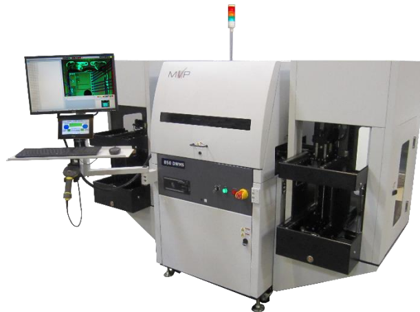
2-11. ábra AOI berendezés [13]
