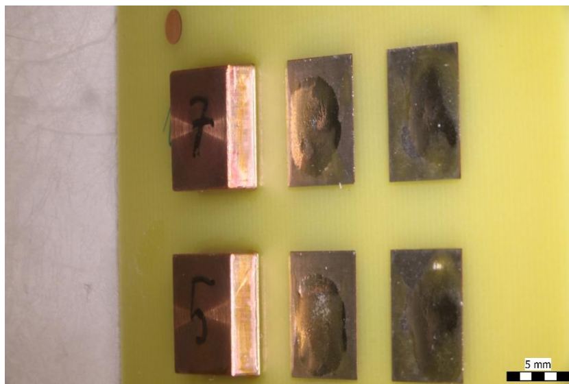
4-12. ábra Forrasztás után oldalról ferde nézetben (PCB0 réztömb 5, 7)
