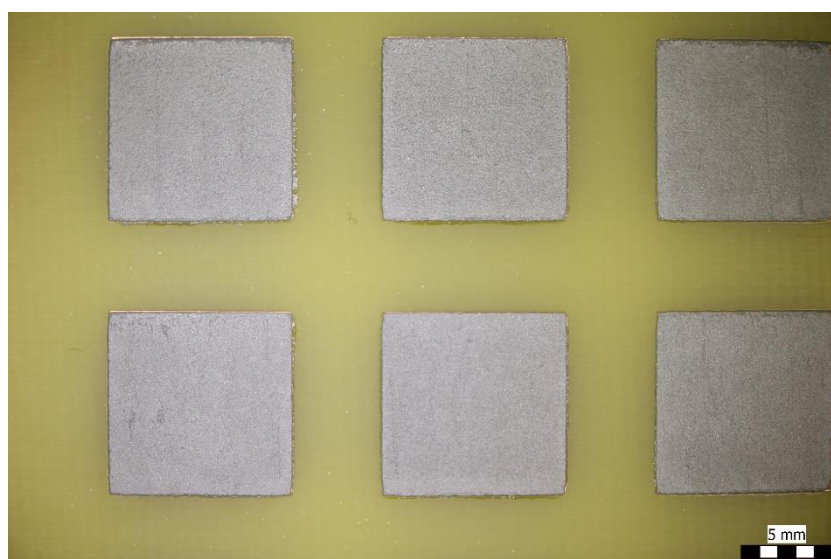
4-7. ábra Forraszpasztta (PCB0 első két sor pad)
