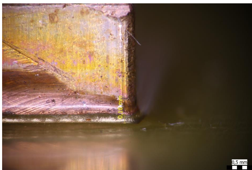
4-13. ábra Forraszprofil (PCB0 réztömb 5)
