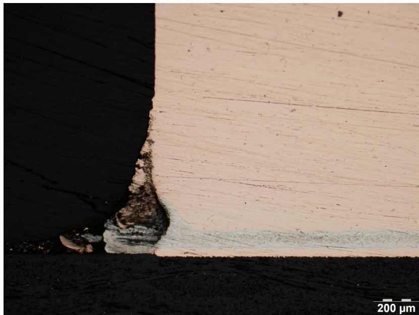
4-20. ábra Elkenődött csiszolat (réztömb 20)
