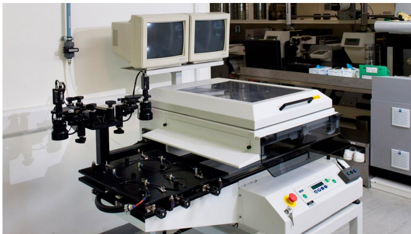
2-6. ábra Stencilnyomtató berendezés [9]
