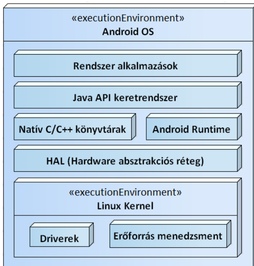
13. ábra: Android operációs rendszerének architektúrája (módosítva [16] alapján)
