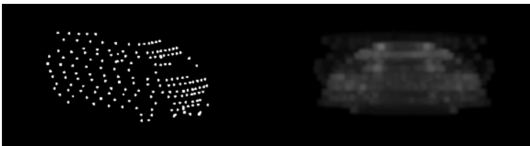
5.4. ábra: Kisteherautó pontfelhő objektumról készült hengeres projekció
