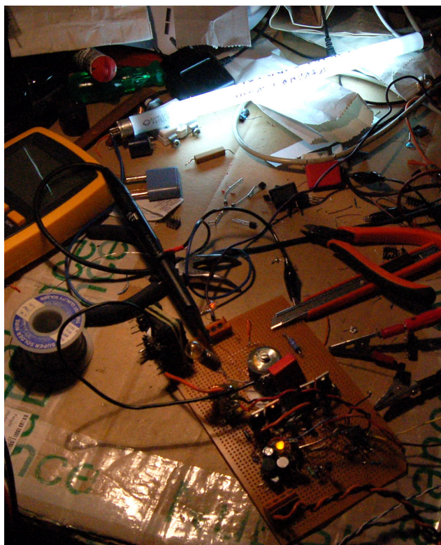
24. Fénykép: a működő inverter próbapanelen összerakva, kiégett izzószerű fénycsővel
