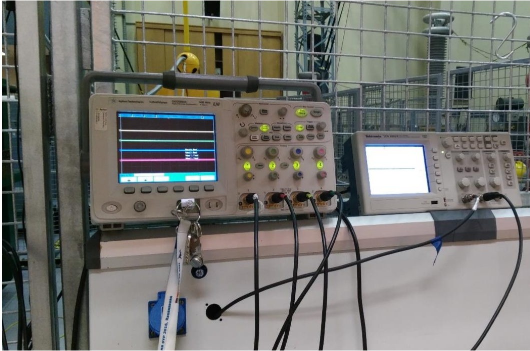
9. ábra: Jelalakok mérése digitális oszcilloszkópok segítségével
