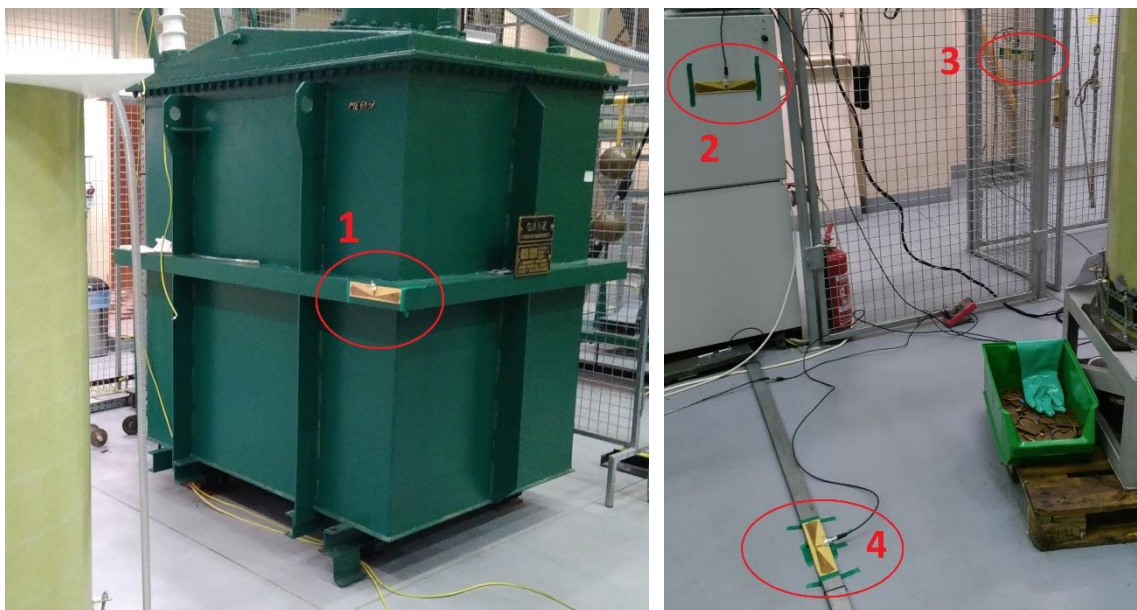
10. ábra: Az antennák elhelyezkedése a mérőtérben
