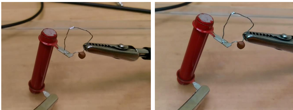
15. ábra: Kisülések a kondenzátor kivezetései között
