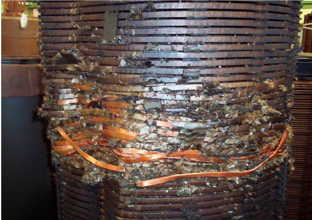
2. ábra: Transzformátor tekercselésének károsodása [2]
