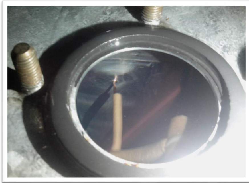
4-15. ábra Hibahely generálás a transzformátorban elektróda kivezetésével
