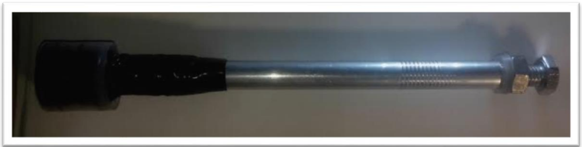
5-1. ábra A mérésnél használt koaxiális csőtápvonal
