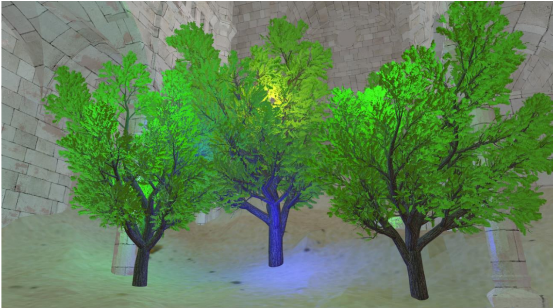
6.4. ábra: Az 1. színtér felépítése és kamera pozíciója. Háromszögek száma: 8.548.456, vertexek száma: 23.820.168.
