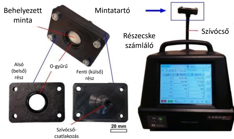
4. ábra: Mérési elrendezés a berendezés és a mintatartó bemutatásával
