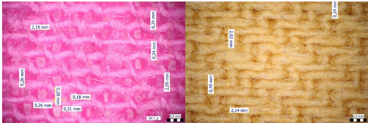
7. ábra: Bal oldalon a feltehetőleg rosszabb szűrési tulajdonságokkal rendelkező anyag, jobbra a valószínűleg komolyabb szűrésre képes anyag – optikai mikroszkópos felvételek
