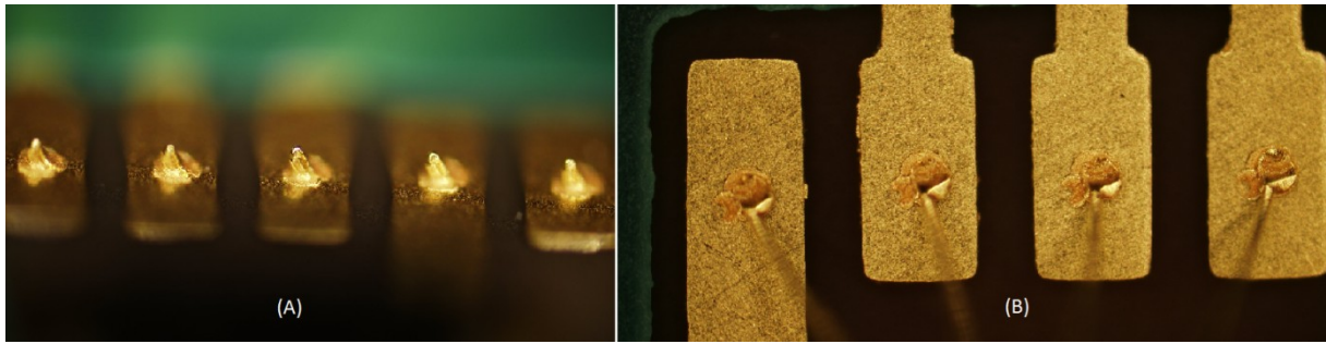
16. ábra (A) A touch-down bump. (B) A touch-down bump-ra kötött stich bond.
