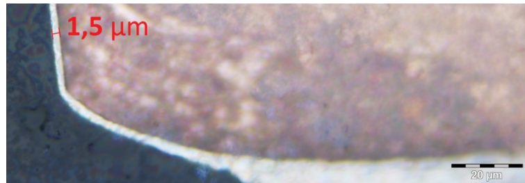
28. ábra Az ENEPIG réteg optikai mikroszkópos felvételén.
