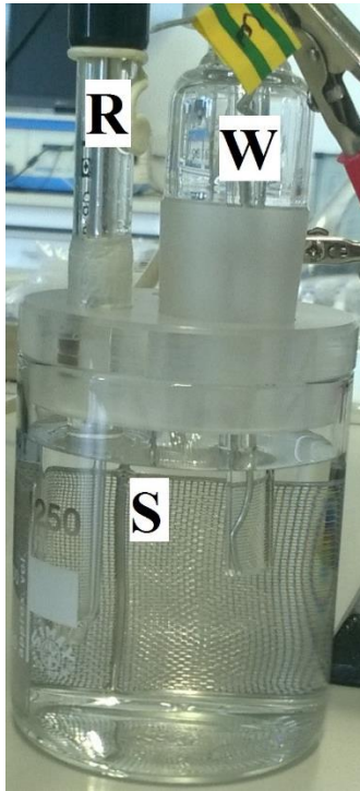
12. ábra: Háromelektrodos mérőrendszer korróziós vizsgálatához (3,5 %-os NaCl vizes oldata).
