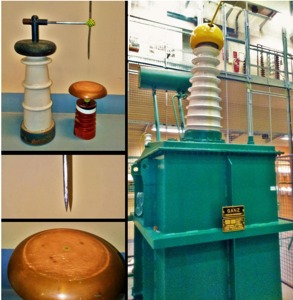
9. ábra: Koronakisülés létrehozásához használt tű-sík elektrópár (bal); A Nagyfeszültségű Laboratórium 250 kV-os próbatranszformátora (jobb)
