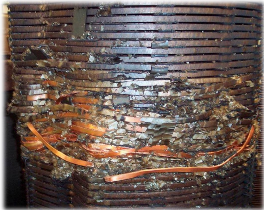
2. ábra: Olaj-papír szigetelés károsodása menetzárlat után [9]
