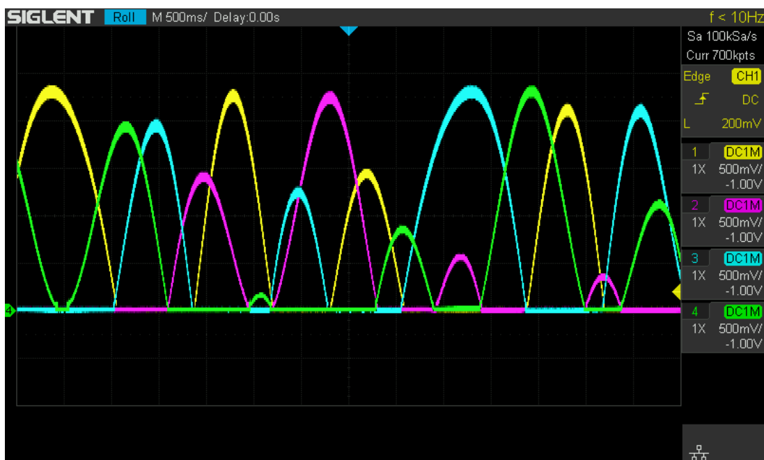
3.15. ábra. Random forgás szimulálása négy panellel, három tengely mentén
