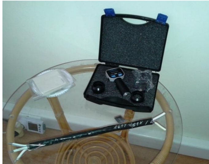
5.1. ábra: HPE II típusú Shore-D keménységmérő és az összehasonlítás alapjául szolgáló kábel
