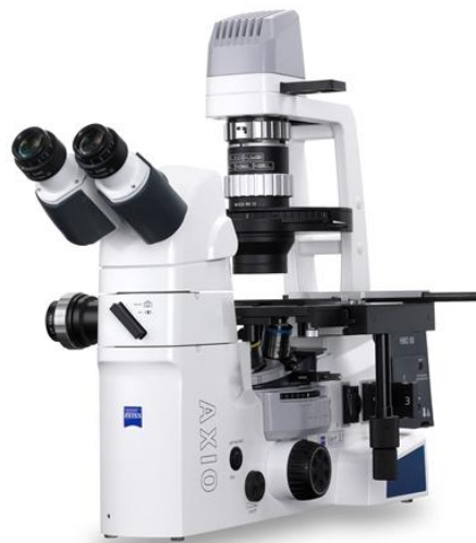
9. ábra: Fluoreszcens mikroszkóp, melynek típusa megegyezik a laborban használttal. [24]
