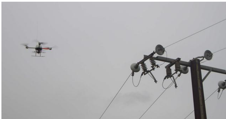
21. ábra. Távirányítású helikopter alkalmazása a távvezeték állapotfelmérésére [30]
