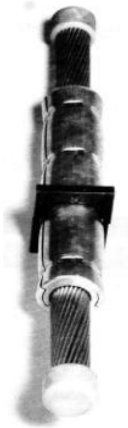
13. ábra. Osztottsíkú javítóhüvellyel megerősített szálkisodródott sodrony
