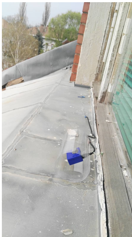
7.7. ábra. Ellenőrző mérésekhez használt szenzor egy épület ablakában.
