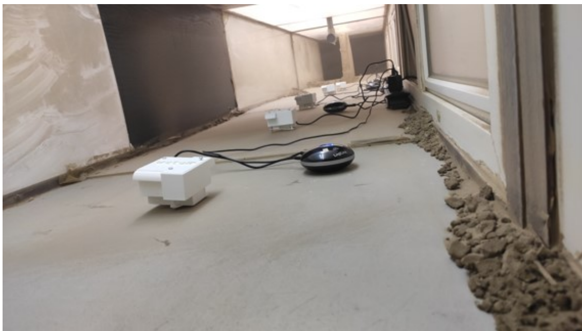
7.2. ábra. Szélcatornás terjedési kísérlet a Debreceni Egyetem szélcatornájában.
