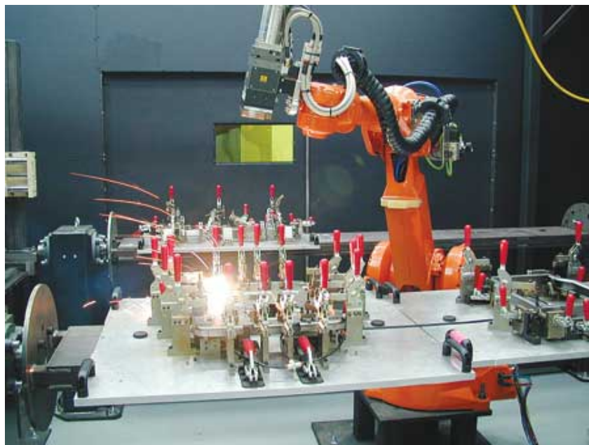
1. ábra. Távoli lézerhegesztés, hegesztő robot [1]
