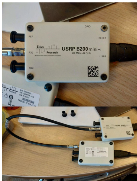
2.19. ábra. Az adó és vevő B200 Mini összekapcsolva a megfelelő csatlakozóikon keresztül
