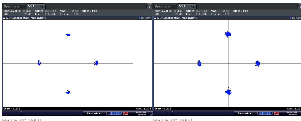
3.13. ábra. A modulált jel konstellációja additív zaj nélkül és additív gaussi zajjal 2.34 GHz frekvencián, 100kS/s
