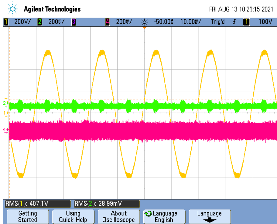
9. ábra - 400 voltos feszültségen száraz földbe helyezett sebzett kábel
