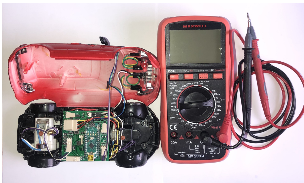
6.1. ábra. Adó és vezérlő áramkör mérési elrendezés
