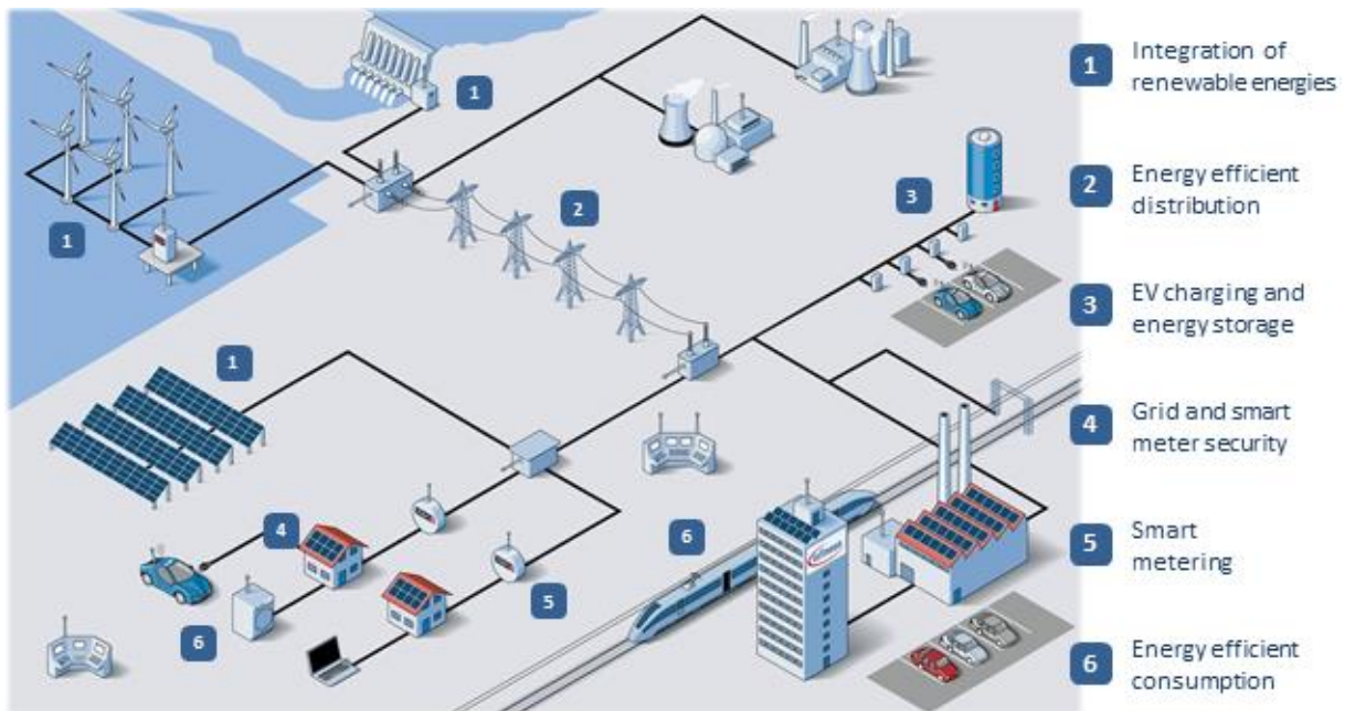
1. ábra Egy Smart hálózat lehetséges felépítése [18]
