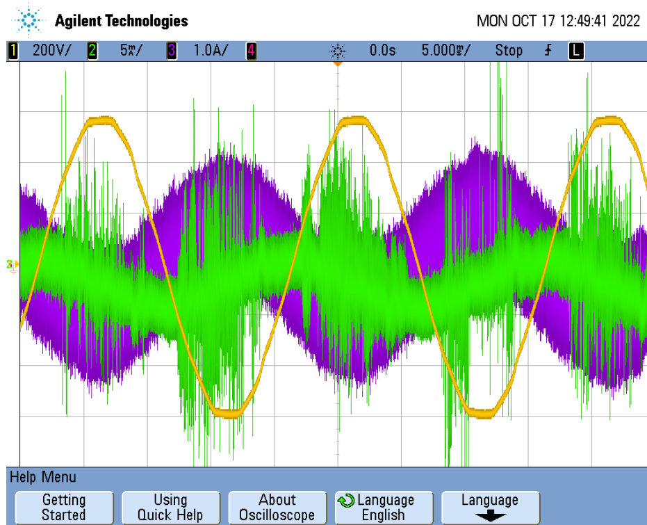
16. ábra - Hagyományos izzóval terhelt hibás kábel oszcilloszkópos képe
