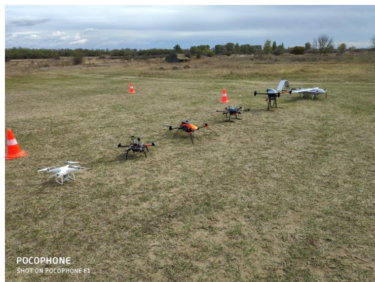
15. ábra: A mérések ideje alatt reptetett drónok, balról jobbra: DJI Phantom4, Quad480, Eurotor4, Tarot680, Secopx8 és Flying Ranger.
