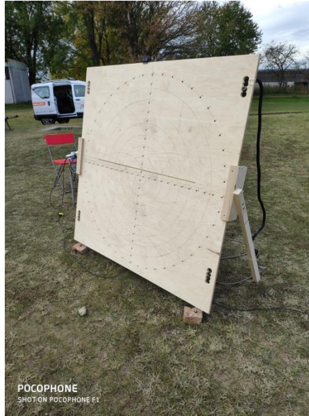
16. ábra: A mérésekhez felhasznált 48 csatornás mikrofontömb, az állvány tetején elhelyezett webkamerával.
