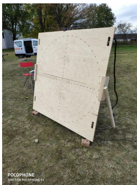
22. ábra: A mérésekhez felhasznált 48 csatornás mikrofontömb.
