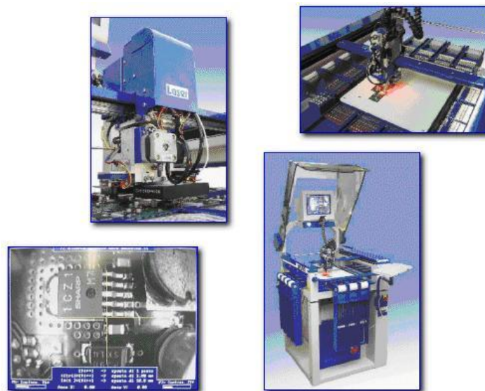
6. ábra. A TWS cég Quadra beültető gépe [6]
