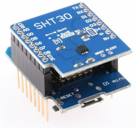
7.6. ábra SHT30 szenzor és esp8266 shield módszerrel összekötve
