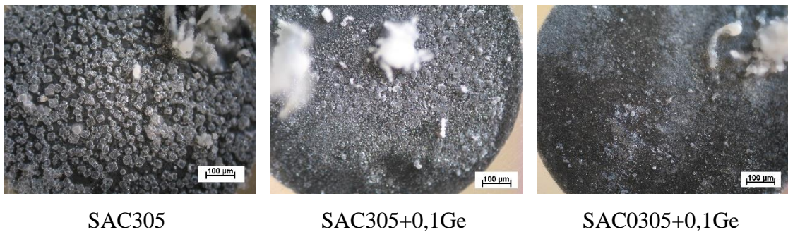
20. ábra A három forrasztótvözet korrózióban részt vett felületének alakulása 0,5 V potenciálon, 200-szoros nagyításban
