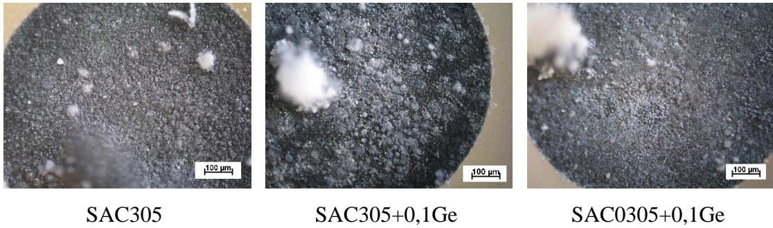
21. ábra A három forrasztótvözet korrózióban részt vett felületének alakulása 1 V potenciálon, 200-szoros nagyításban
