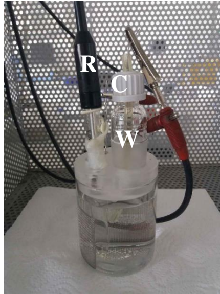
5. ábra Az összeállított elektrokémiai cella az elektródok jelölésével (R: referenciaelektród, C: ellenelektród, W: munkaelektród)
