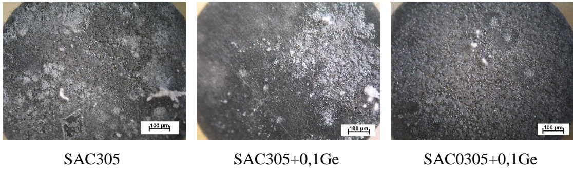
19. ábra A három forrasztótvözet korrózióban részt vett felületének alakulása 0 V potenciálon, 200-szoros nagyításban
