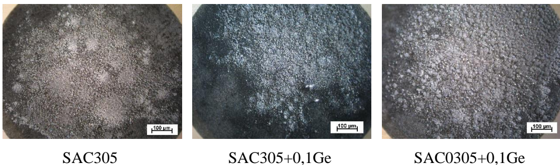
18. ábra A három forrasztótvözet korrózióban részt vett felületének alakulása -0,2 V potenciálon, 200-szoros nagyításban
