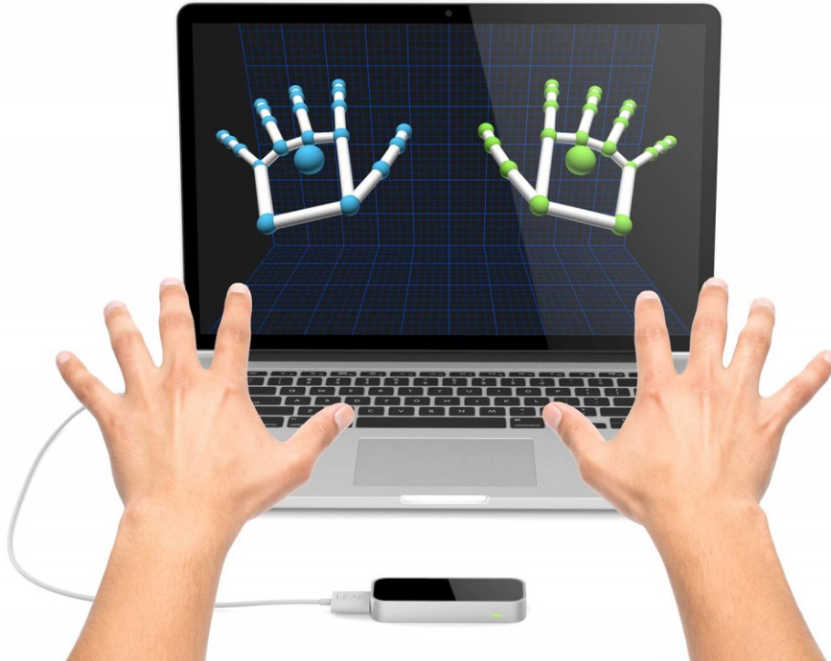
12. ábra Leap Motion szenzor - látható a laptopon a kezek virtuális reprezentációja minden ízülettel 4
