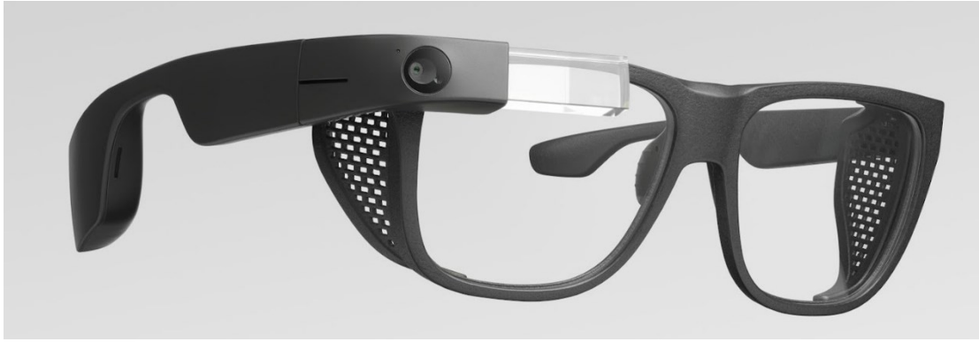
1. ábra Google Glass Enterprise Edition 2 eszköz - kicsi, könnyű, de csak egy kis képernyővel rendelkező eszköz. A képen látható munkavédelmi szemüvegkeret kifejezetten ipari felhasználásra lett kifejlesztve. 1
