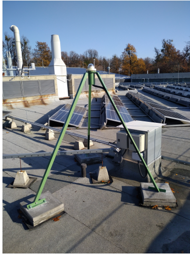
(a) Starlight Xpress Oculus típusú égbolt kamera az EK telephelyén.
