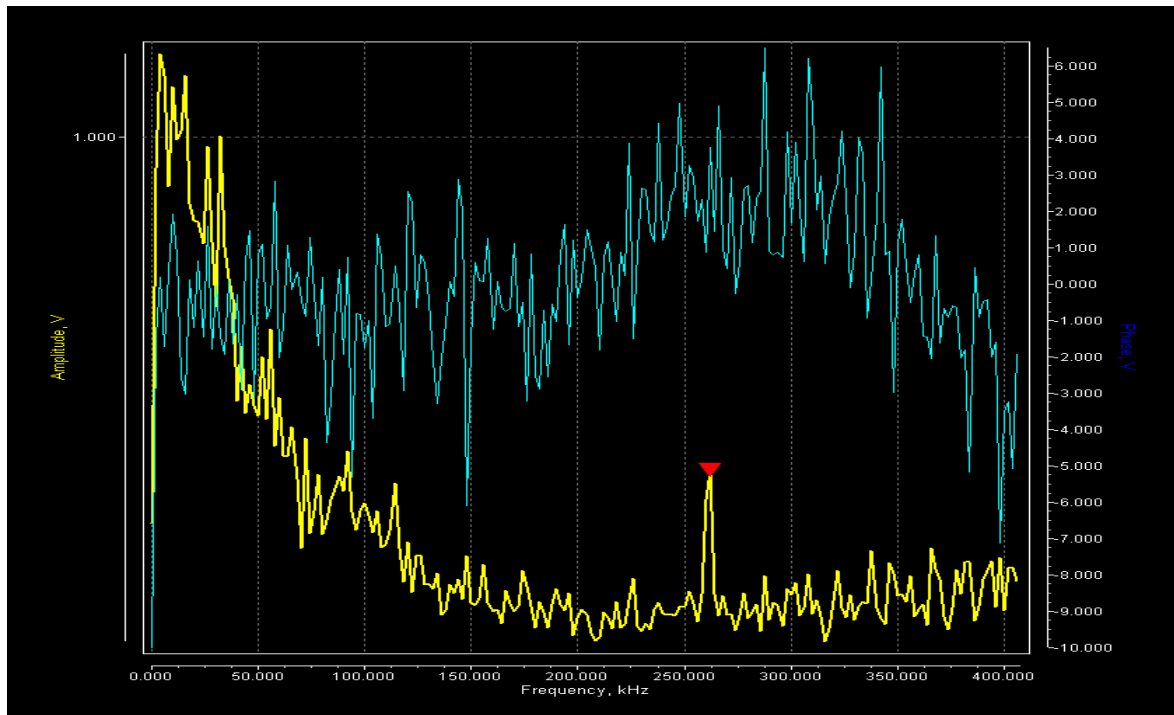
16. ábra BME ETT laborjában található VEECO AFM-el mért FluidFM konzol zajspektruma levegő közegben mérve.
