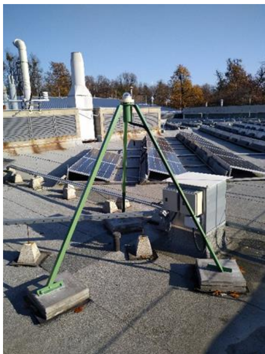
1.1. ábra: Starlight Xpress Oculus típusú égbolt kamera az EK telephelyén. Háttérben a napelempark.
