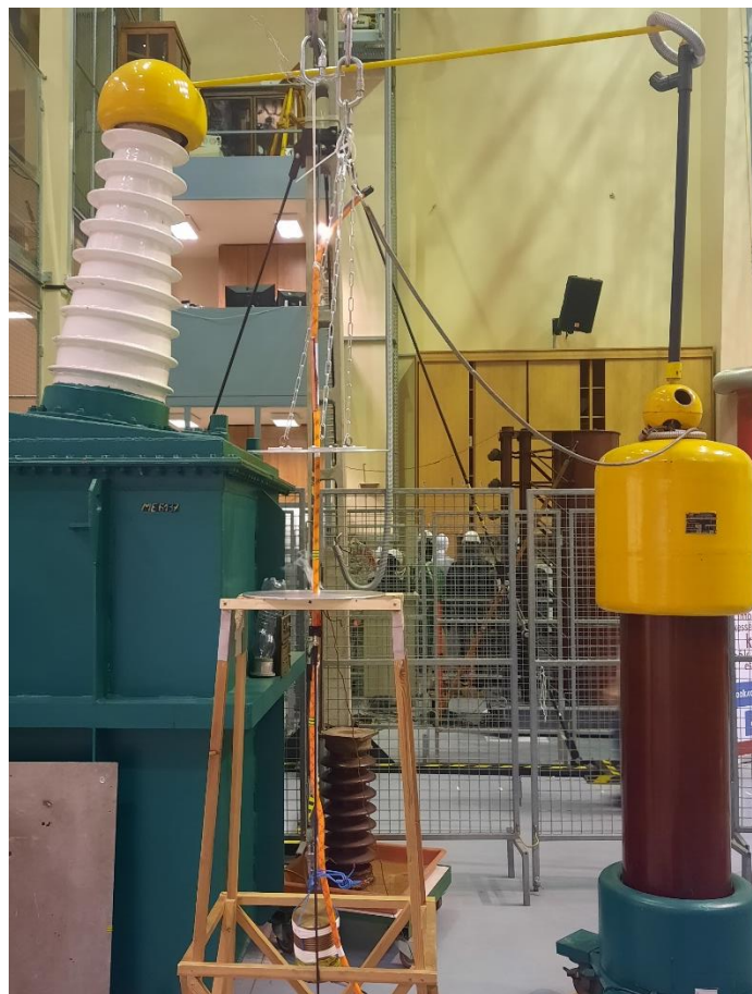
16. ábra K6 mintadarab átütése
