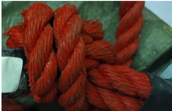
10. ábra FAM-kötél végződésénél felületi sérülések
