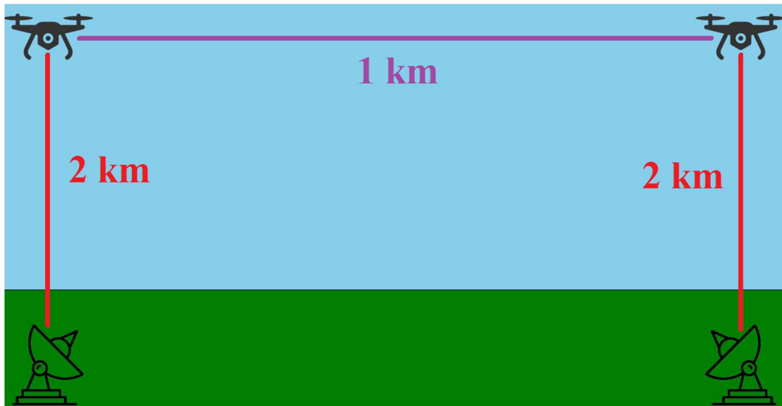
12. ábra: Második rendszer, amikor megbízunk a drónokban így a két végponttal szomszédos 1-1 drónnal megy végbe két kvantumkulcsszétosztás.
