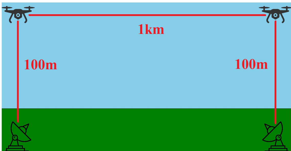
11. ábra: Első rendszer, amikor nem bízunk meg a drónokban így csak továbbítóként működnek. A pirossal jelölt vonal jelzi a kvantumcsatornát.
