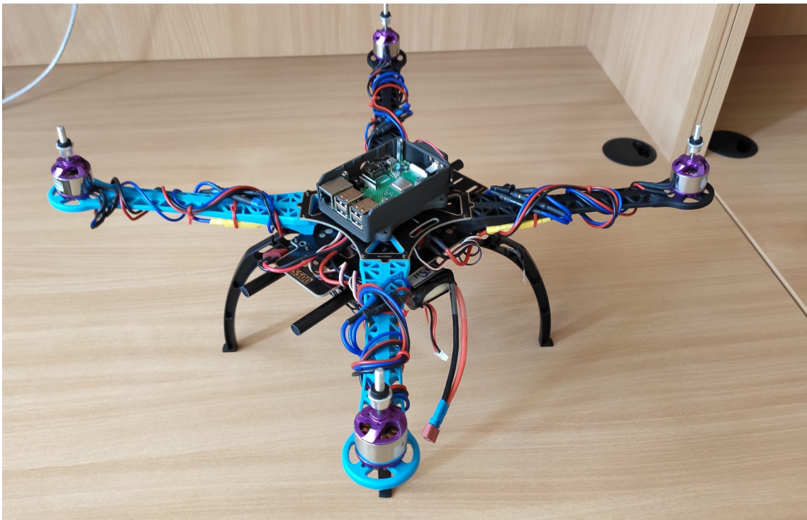
4.1. ábra. Az összeszerelt drón (propellerek nélkül)
