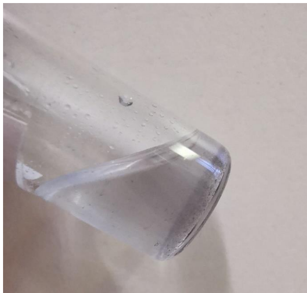
10. ábra Fázistranszfer során aggregáló nanorészecskék
