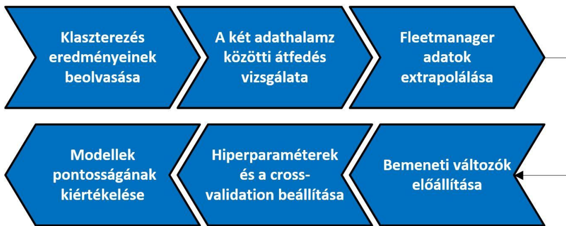
3.17. ábra: Az adathalmazok előkészítése a regresszióra
