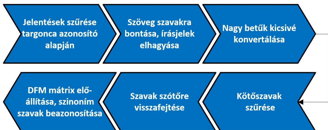
3.10. ábra: A szöveg feldolgozásának folyamata
