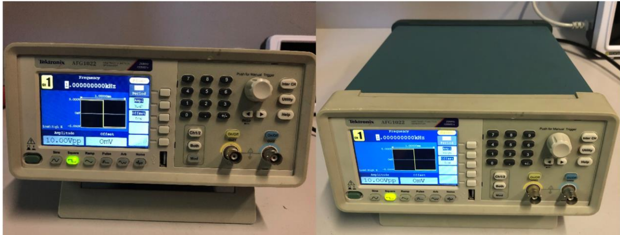
58. ábra: A vasmag méréshez használt jelgenerátor
