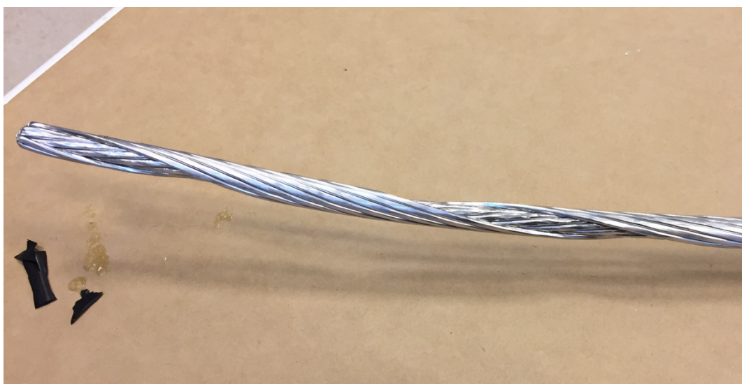
4.5-3. ábra: A 95 mm 2 AASC sodrony felépítése
