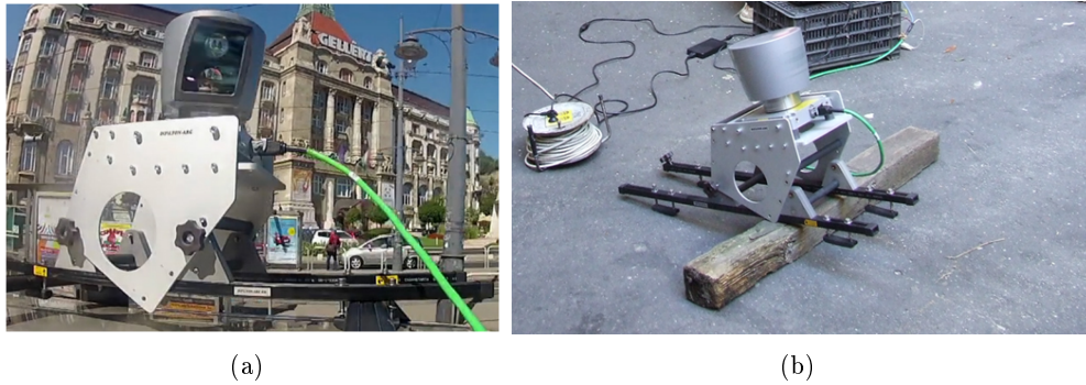
2.2. ábra. LiDAR használati módjai. a) jármű navigációra használt, nem döntött. b) döntött, video-megfigyelési használat.
